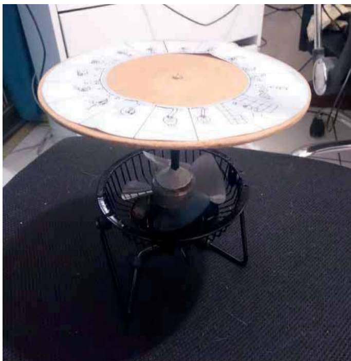
Figura 11 – Estroboscópio com ventilador USB Fonte: Elaborado pelo autor
