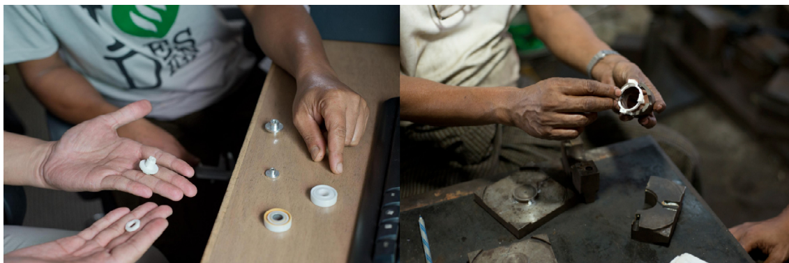
Figura 22. Anéis espaçadores impressos em 3D para a Proximity Designs.
